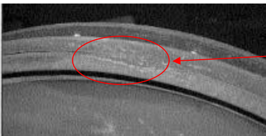
Bild 8 Ungleichmäßige Kontaktfläche über den Umfang des Radkranzes
